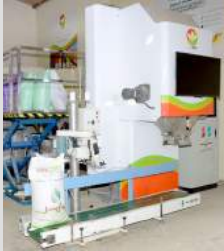
Le Smart Blender, un outil de production de proximité d'engrais sur mesure pour une fertilisation intelligente et personnalisée.
