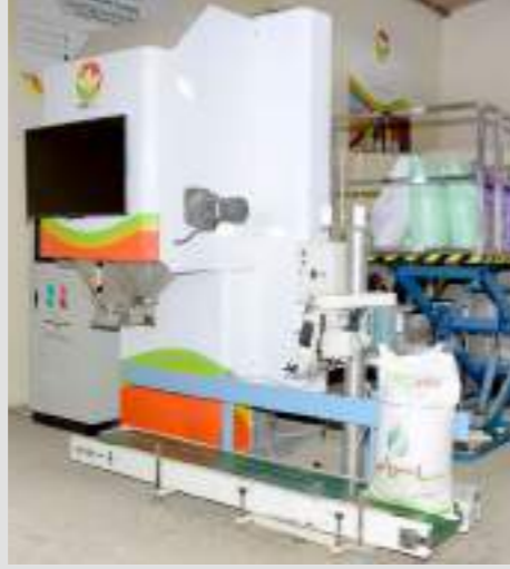
الوحدة الذكية للسماد NPK الممزوج، أداة إنتاج الأسمدة المشخصة.
